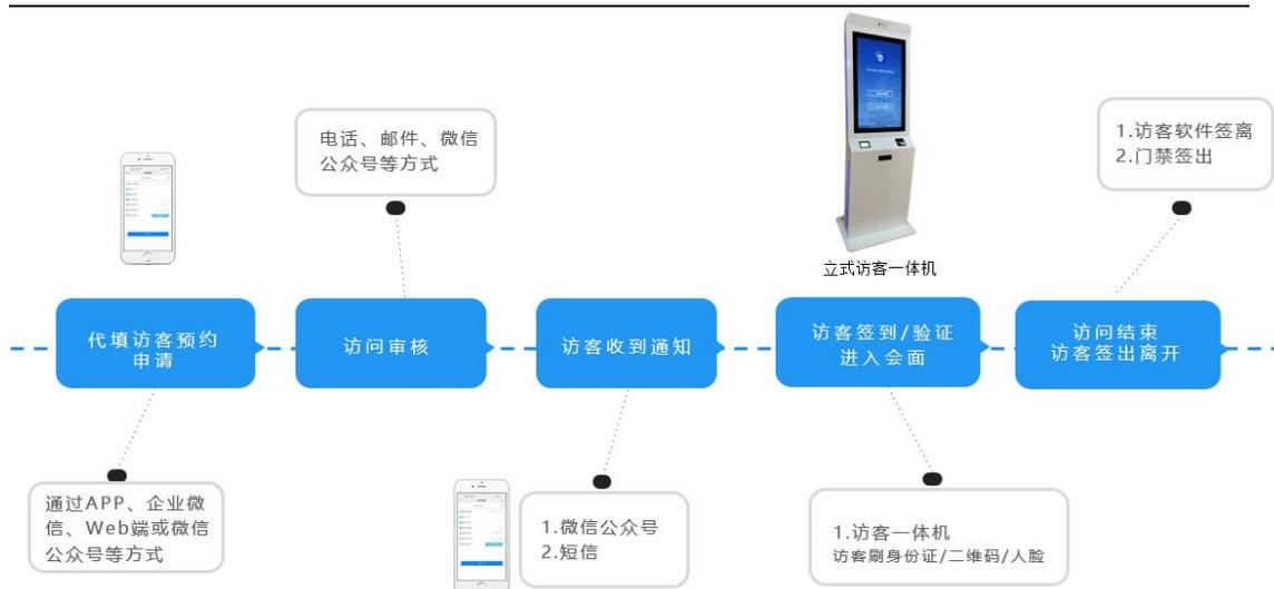
某研发中心访客系统，将 AFS 系统和企业微信对接，内部员工帮访客代填访客单，信息填下完成提交审核，审核通过后发送预约短信给访客，访客收到短信通知，点击短信链接获取访客二维码，此时的访客二维码是无效的，直接扫码无法开门。访客到达大厅，在自助访客机上刷身份证或者输入证件号码，确认身份信息，身份确认无误后，获取的二维码生效，访客在访问时间内可通过二维码读卡器扫码通行。
